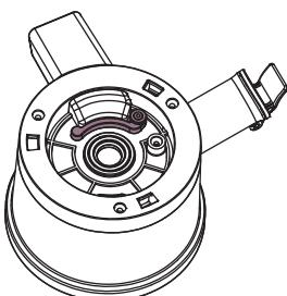
2. Под чашей размещен силиконовый колпачок, используемый для отделения мякоти. Проверьте, плотно ли он вставлен.
