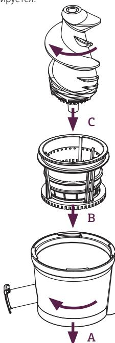
3. Вставьте в чашу выжимной винт. Выжимной винт должен быть полностью вставлен в чашу, иначе изделие не будет работать, а крышка не закроется.
