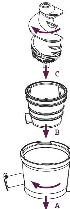
3. Uzlieciet padeves tvertni. Savietojiet bultīju uz padeves tvertnes ar atbloķēšanas simboli spiešanas tvertnes augšejā daļā. Pagrieziet, lai nosifikētu padeves tvertni un savietotu bultīju ar bloķēšanas simbolu.
